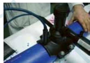
7 Считать маркировку на фитинге с помощью устройства для считывания штрихкодов сварочного аппарата. На аппарате появляется сигнал START (ПУСК) для запуска процесса сварки. Нельзя изменять положение сварки на протяжении всего процесса сварки.
