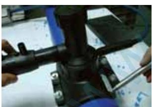
9 Режущий механизм, расположенный в верхней точке Т-переходника, вращается по часовой стрелке с помощью 14 мм шестигранного ключа для разрезания трубы.
